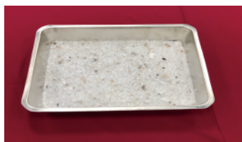
▲ 破碎法的結果 主體為玻璃粒，並且包 含少量EVA/背板/Ribbon
