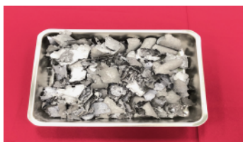
▲ 破碎法的結果 主體為背板+EVA，並且 包含有玻璃/矽/Ribbon
