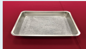
▲ 破碎法的結果 主體為矽粉+玻璃粉，並 且包含少量EVA/背板
