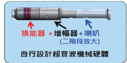
超音波機電轉換及機械放大系統
