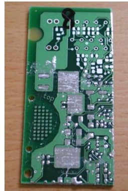
裸銅經浸鍍錫線路板 浸鍍錫線路板經沾錫性測試結果
