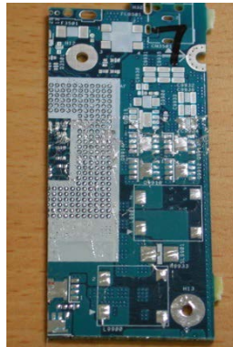
裸銅經浸鍍錫線路板 浸鍍錫線路板經沾錫性測試結果
