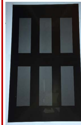
5.5吋手機用AMOLED熱蒸鍍用金屬罩
