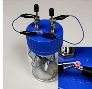
▲圖三 固態鈉二氧化碳(Na-CO<sub>2</sub>)電池點亮紅色LED
