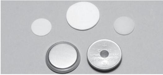
▲圖二 中國製釉固態電解質陶瓷片應用於鈕扣電池
