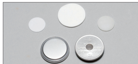
▲ 圖二 中國製釉固態電解質陶瓷片應用於鈕扣電池
