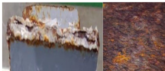
▲圖九 金屬不同程度的腐蝕失效圖
