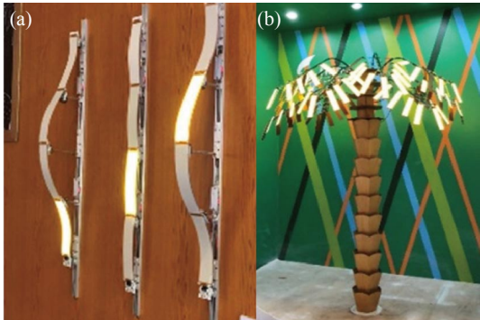
▲圖七 2018照明展展示3-tandem OLED照明之 (a)自由曲度OLED；(b) FOLED光之樹
