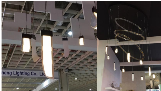
▲圖五 「FOLED」(Flexible OLED)光引擎，上方黑色結構為電子機構接口，搭配方框設計整合FOLED介面，整體尺寸為5公分×20公分
