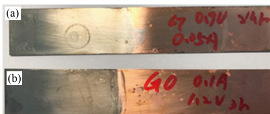
▲圖三 銅底材離子電鍍鎳與(a)石墨烯；(b)氧化石墨烯共鍍之表面形貌
