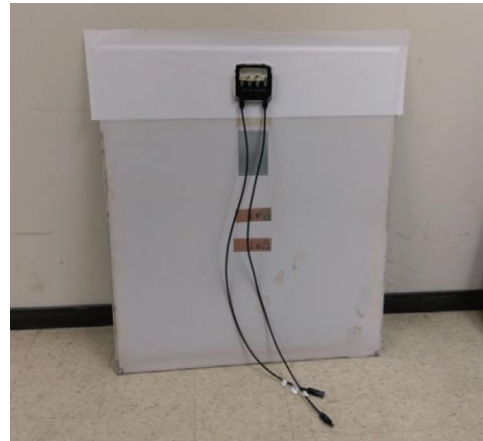
▲圖十四 鋪上EVA及背板並進行模組之壓合，EVA與壓合已經接著在舊模組上，並已經裝上新的接線盒
