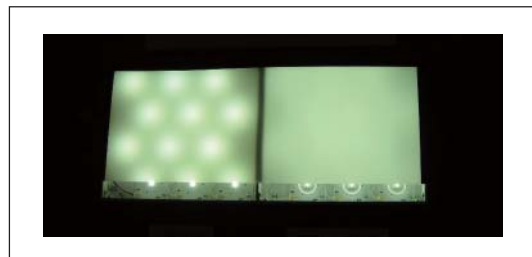
▲圖十七 Lighting Cap 與擴散板的結合應用例
