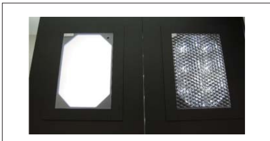
▲圖十六 三菱工程塑膠所開發的高效率 PC 擴散板與一般晶晶板之比較
