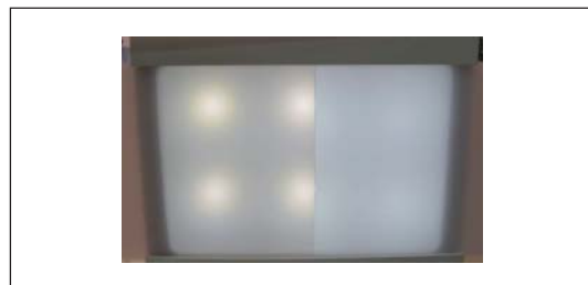
▲圖十九 SABIC PC 表面粗化擴散板均勻性對比（右側）
