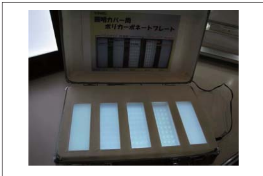
▲圖十四 不同光透過率與均一性擴散板的平衡比
