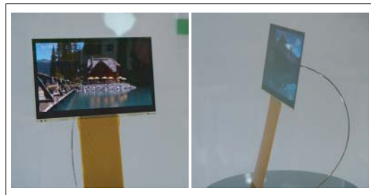
▲圖五 Sony 在 FINETECH JAPAN 現場展示厚度僅約 2mm 的 3.5 吋超薄型 OLED 原型
