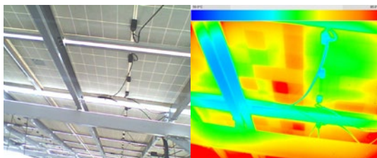
▲圖七 半切模組因大面積遮陰之熱影像檢查結果（彩圖請見材料世界網）
