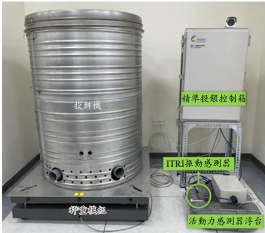
▲圖一 精準投餌系統雛型機
