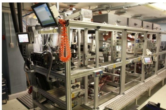
▲圖一 卷對卷凹版印刷機 (2)
