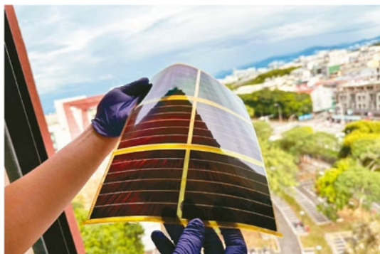
▲圖七 台灣鈣鈦礦科技公司第一片軟性鈣鈦礦太陽能電池
