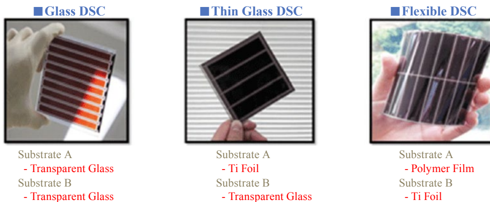
▲圖八 染敏電池模組的三種型式
