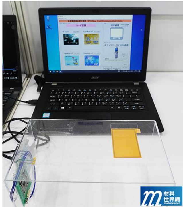
圖九、DNP 展出 5G 用透明天線薄膜，光線穿透率達 86%以上
