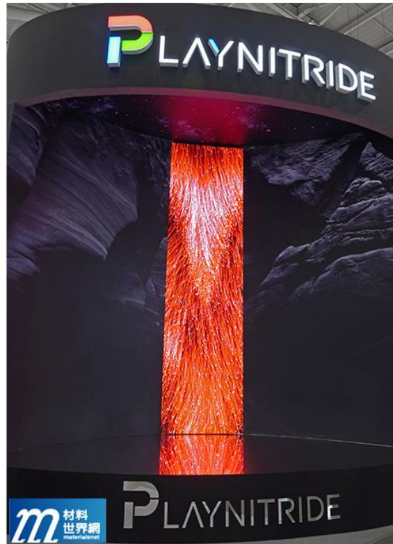
圖二、臻創採用超大拼接方式，呈現出 Micro LED 做為大型看板的可能性
