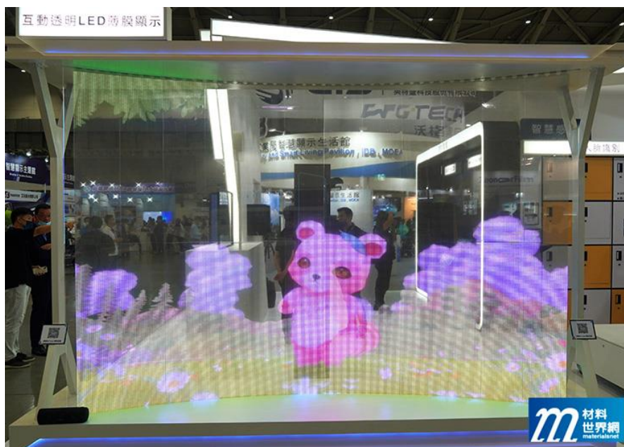
圖十、大尺寸互動透明 LED 薄膜，提供公共空間資訊顯示解決方案
