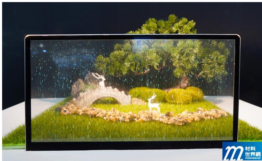
圖三、9.38 吋透明 Micro LED 顯示器，將前景雨絲與背景實物結合為一體
