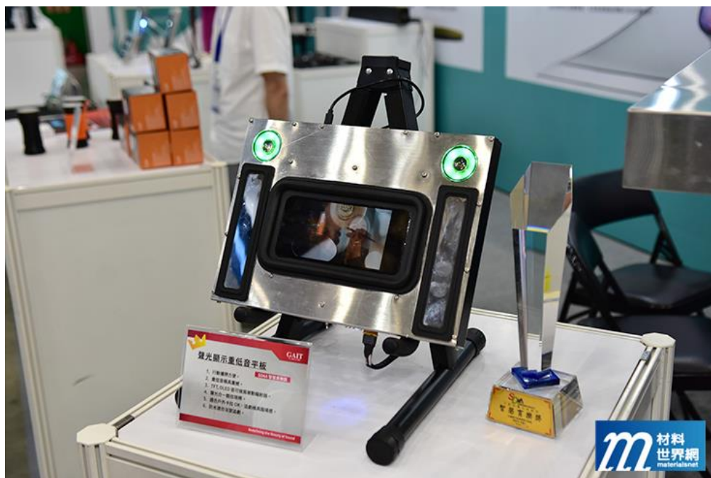
圖十五、玻音利用玻璃做為發聲媒介，LED 螢幕是重低音組成的一部分
