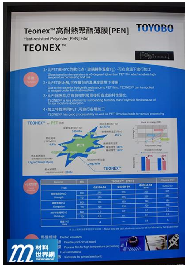
圖十三、東洋紡 PEN 材料解決既有 PET 材料在絕緣、耐熱方面的問題
