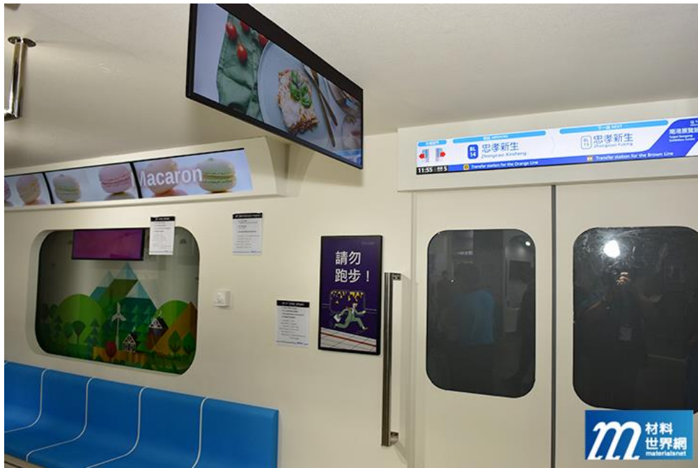
圖五、智慧顯示車廂結合 LED 顯示、三種電子紙等不同技術，進行實車驗證
