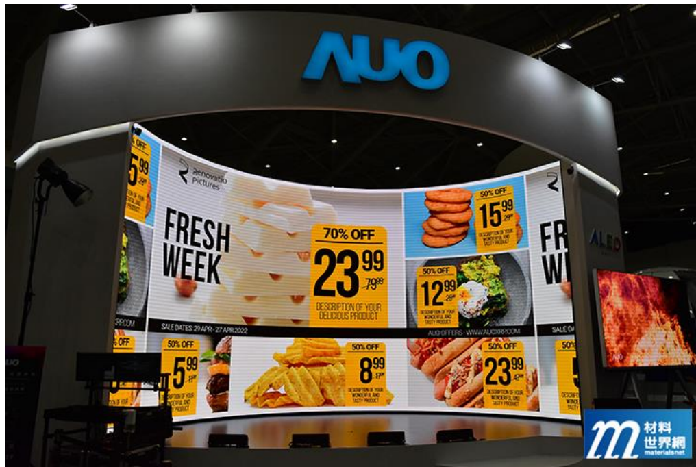
圖二、友達利用曲面顯示器無縫拼接，各像素均能獨立驅動發光
