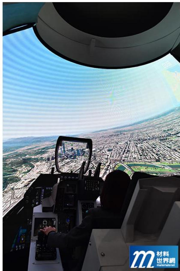
圖三、以球體座艙進行飛行模擬能涵蓋所有視角，強化擬真度
