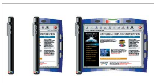
▲圖八 類紙式軟性顯示器示意圖
