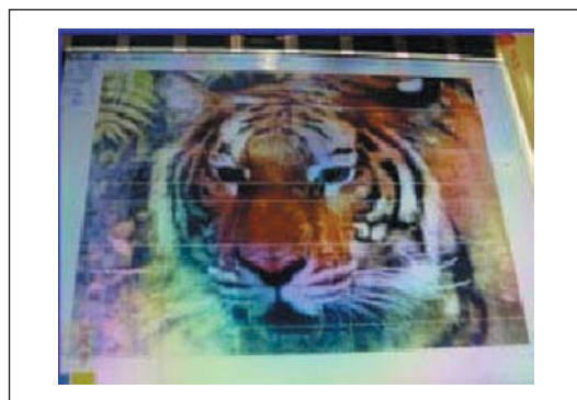
▲圖六 Samsung 於 2005 年發表 15 吋 XGA 穿透式液晶顯示器於玻璃基板
