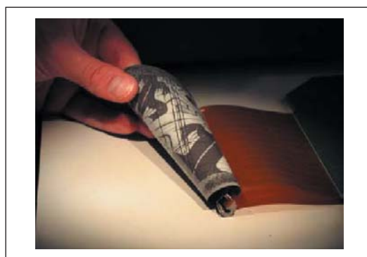
▲圖七 Philip 於 2005 年發表以 OTFT 製作的 5 吋電泳式軟性顯示器
