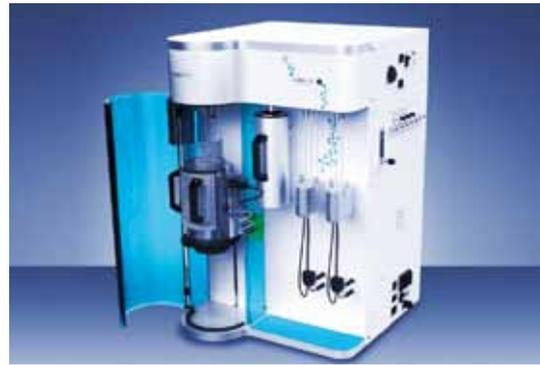
孔分析的重要手段。PoreMaster具液態汞導入和自動油淨化等功能：螺桿驅動提供控制和智能壓力，完成最終據解分析；並且可在30分鐘內完成液態汞填充、低壓測量以及高壓測量。壓汞儀可測量孔徑1,080  $\mu\text{m}$ ~3 nm，Porometer則是可測量孔徑大小0.013~500  $\mu\text{m}$ ，可應用於巨孔固體粉末、塊狀及薄膜材料的孔徑分析。分析範圍廣且樣品相容性強。
