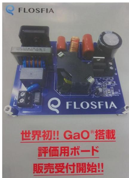
▲圖十四 FLOSIFA電源功率轉換模組，用於DC/DC電源轉換模組設計及功率應用
