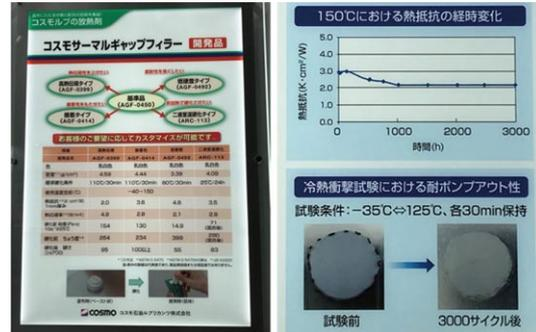
▲圖八 Cosmo Oil推出高導熱TIM材料，具快速硬化與耐熱性
