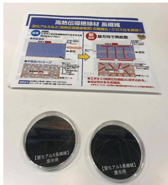
▲圖九 中央電子工業展出高散熱特性氮化鋁纖維，標榜可提升10倍散熱效率
