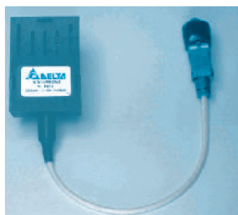
▲圖十四 1×9 形式光纖輸出 SC 接頭 BIDI 光收發信模組
