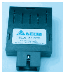
▲圖十三 1×9 形式 SC 接頭 BIDI 光收發信模組
