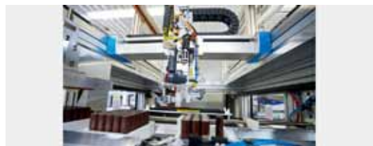
• 以平面龍門EXCH踏出創新的一步：該電動汽車電池試點組裝線中採用的自動化科技，原先開發用於太陽電池的生產。非常適合抓取精密元件，並以高精度置入
