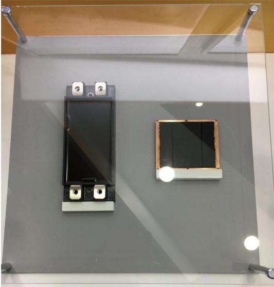
▲圖九 日本合成化工公司展示液態封裝材料應用於功率模組封裝之實品
