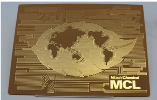
▲圖五 日立化成低傳送損失/低熱膨脹多層材料MCL-HS100實品
