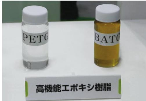
▲圖七 昭和電工超低氯環氧樹脂 (PETG、BATG) 樹脂樣品
