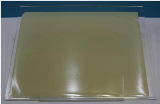
▲圖四 日立化成低介電損失增層薄膜材料MCF-400HS實品
