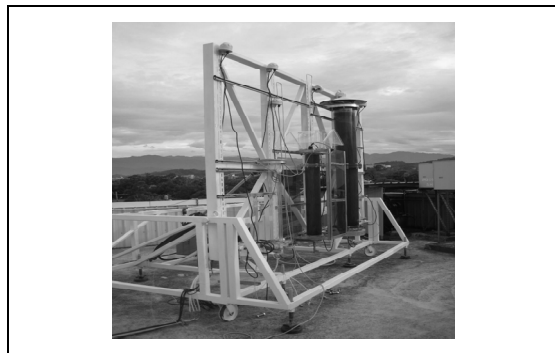
▲圖七 可調整反應器角度支撐架台
