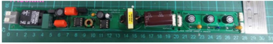
▲圖十五 工研院綠能所開發之LED低閃爍電源供應器雛型產品
