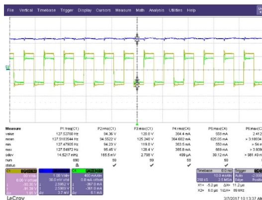
▲圖十一 複金屬燈以方波電流供電之燈管電壓、電流及輸出光波形
