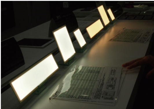
▲圖六 日本Lumiotec展示之冷、暖色系白光OLED元件
