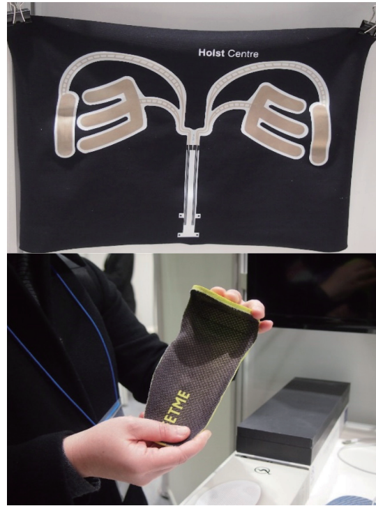
▲圖十四 杜邦公司具伸縮性導電油墨具高電路設計自由度，可提供不同基材穿戴式產品解決方案
