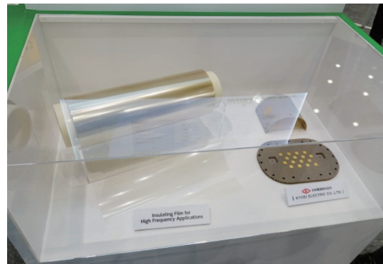
▲圖七 日本NAMICS低介電損耗絕緣材料及其展品
