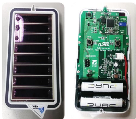
▲圖九 工研院開發DSC自供電無線溫濕度測節點
