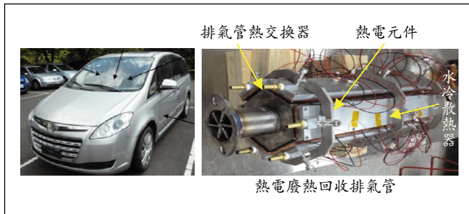
▲圖九 熱電廢熱回收排氣管實體及實車安裝
