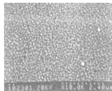
▲圖六 Acrylic基材經RIE處理15min所得到的SEM結果
