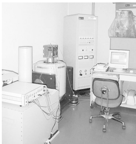
▲圖六 振動測試設備及瞬間斷電監測系統
