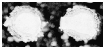
◀圖二 拉伸試驗之破壞元件一介金屬層破壞
