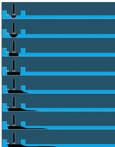
► 圖十二 光阻自Slot流出塗佈在玻璃基板之連續變化
