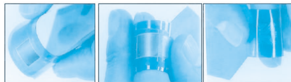
▲圖十四 25 \mu\text{m} 超薄16Mb快閃記憶體晶圓構裝 (Source: Irvine Sensor Tech.)
