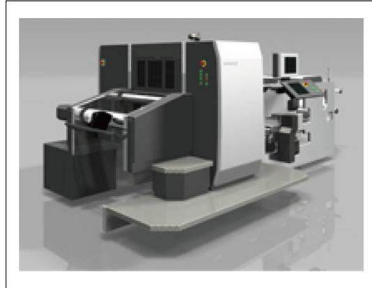
▲圖十一 Komori PEPIO R20高速凹版微細線路印刷機，最窄線寬可達5  $\mu\text{m}$
