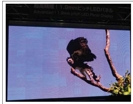
▲圖四 SiliconSign展出由環氧樹脂銅箔積層板組合的LED電視
