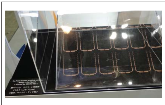
▲圖十三 Asahi Glass公司採用銅膠製作導線的試作品
