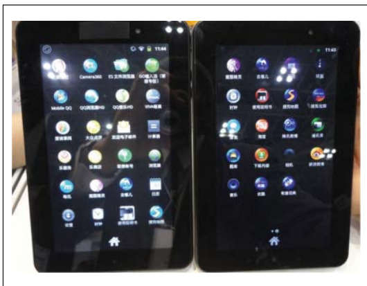
▲圖六 遠東新世紀公司展出以奈米碳管製作投射式電容式觸控顯示面板(左為商品實機，右為貼有奈米碳管導電膜的試驗機)
