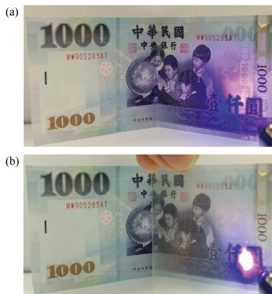
▲圖四 利用驗鈔筆照射新台幣上的防偽線(a)未放置任何物品；(b)使用丙樣品
