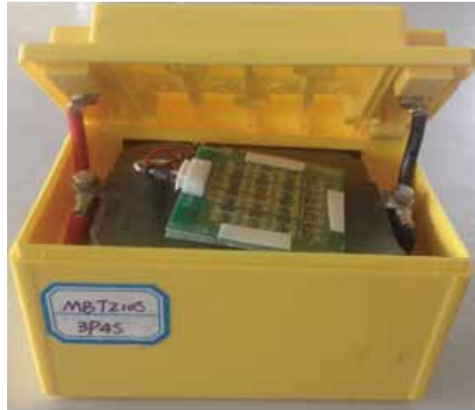
▲ 圖一 摩托車鋰鐵啟動電池 (LiFePO 4 battery)
