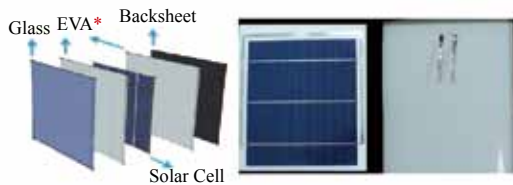
▲ 圖六 太陽能電池抗PID測試封裝
