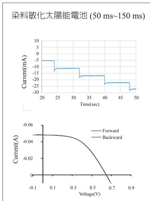
不同元件，達成平衡時間不同，因材料特性導致不同磁滯現象。工研院/量測中心發展創新電池I-V量測技術，可有效解決新穎太陽能電池I-V量測。☒
