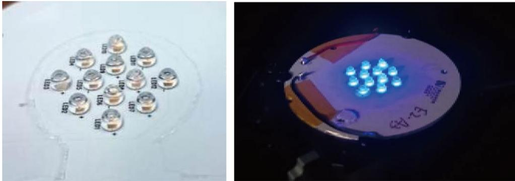
▲圖十五 反應式射出封裝光引擎測試
